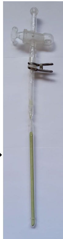
Verschließen der Ampulle im Hochvakuum: 10^{-6} mbar
