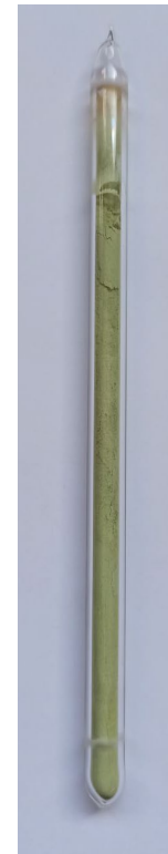
Verschließen der Ampulle im Hochvakuum: 10^{-6} mbar
