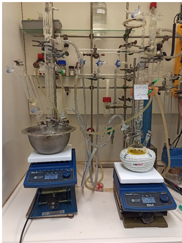
Arbeiten unter Schutzgas
